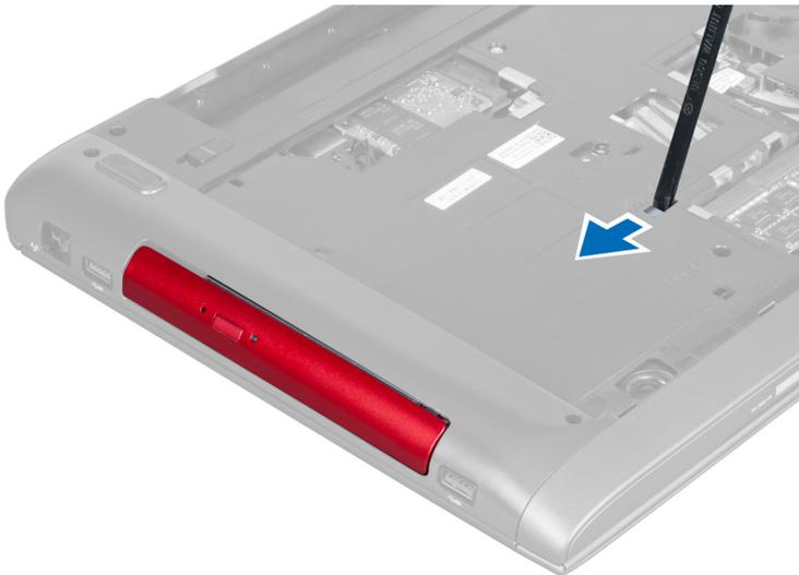
5. Faça deslizar a unidade óptica para fora e retire-a do computador.
