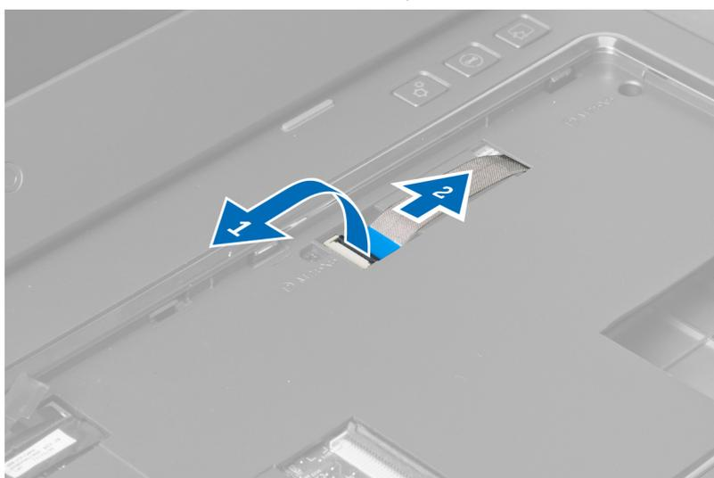
7. Desaperte o parafuso e retire o cabo de LVDS da placa de sistema.
