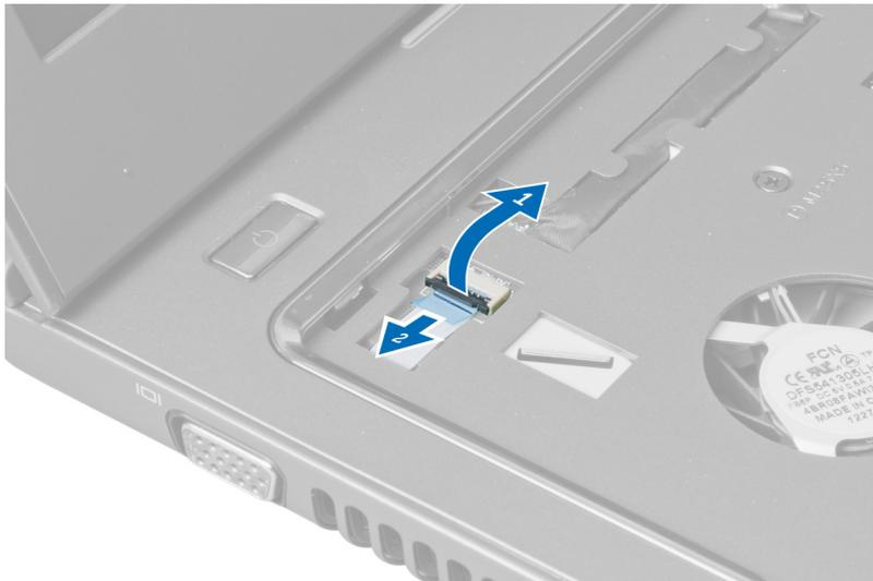
5. Solte o trinco e desligue os cabos de impressões digitais e do painel táctil.
