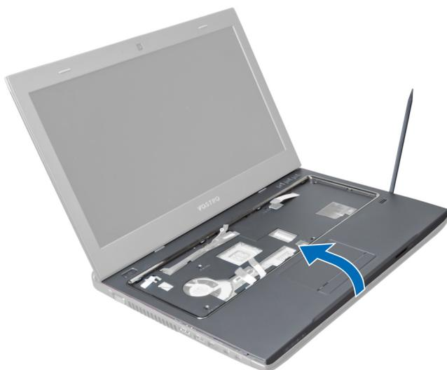
11. Faça deslizar o apoio para as mãos para fora e levante para o retirá-lo do computador.
