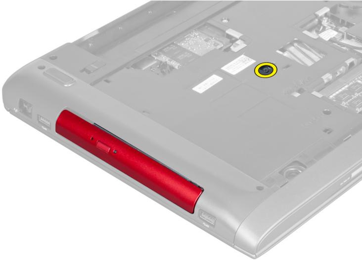
4. Utilize um parafuso de cabeça chata para levantar a unidade óptica do computador.
