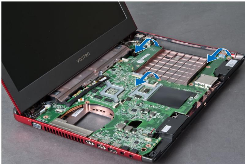
7. Faça deslizar a placa de sistema e levante-a para fora do chassis.
