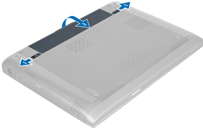
3. Levante e retire a bateria do computador.
